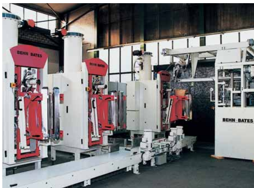
3 пневматических упаковочных установки с автоматом-насадкой клапанных мешков и станцией закрытия, смонтированной на манипуляторе насадчика
