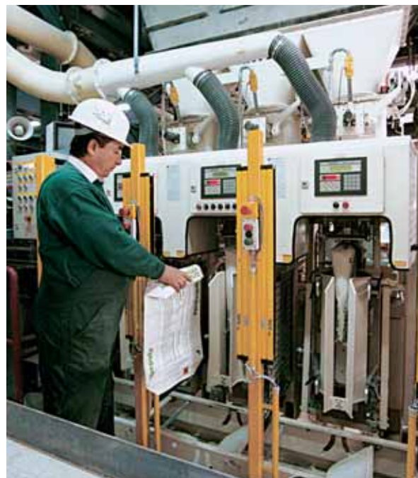
Стационарная установка с ручным или автоматическим управлением для фасовки в клапанные мешки
