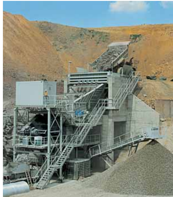
предварительные дробильные установки HAVER & BOECKER, производительность 500 тонн в час
