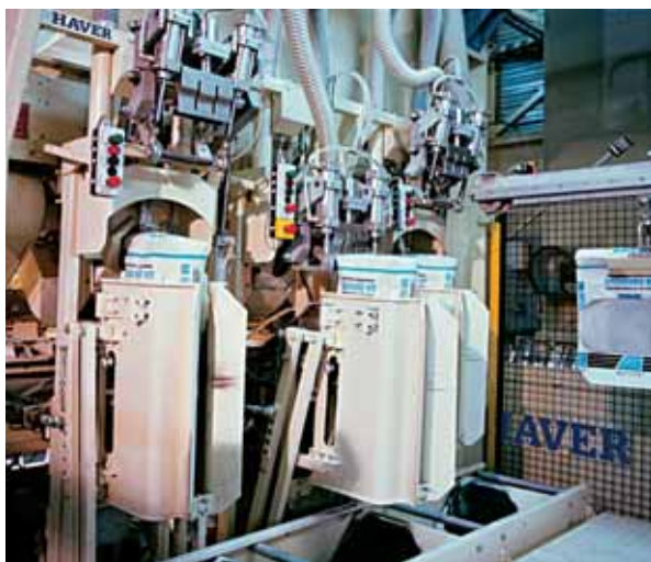
Затаривающая машина для клапанных мешков, предназначенная для порошкообразных продуктов
